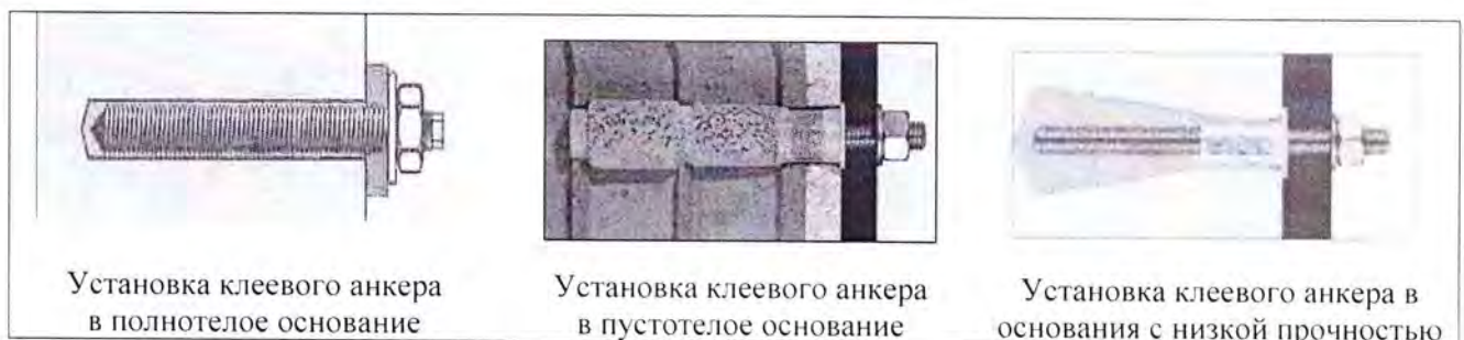
Рис.3. Примеры установки клеевых анкеров в различных основаниях
